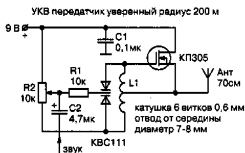
Рис. 25.11. Оригинальная схема передатчика FM
